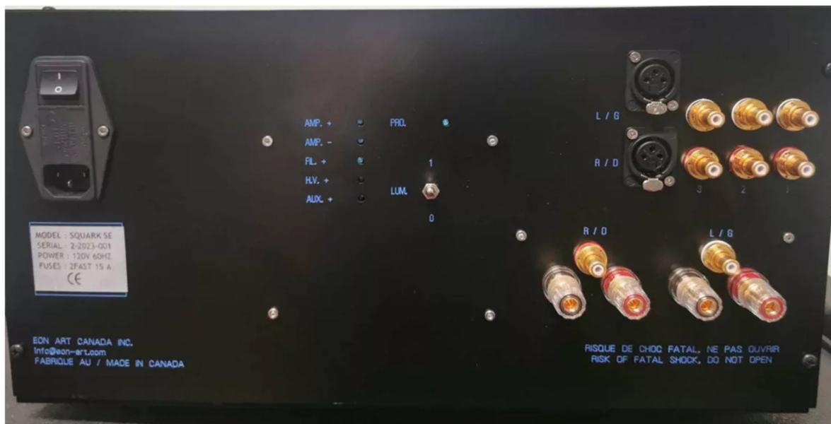
La face arrière regroupe 4 entrées Ligne : 3 sur connecteurs RCA d'origine Neutrik 1 sur connecteurs XLR boulonnés directement sur le châssis et isolés de celui-ci. Une autre paire de connecteurs RCA est réservée à la sortie Ligne. Les 4 bornes HP sont issues du catalogue Supra. Elles acceptent le fil nu, les fourches et les fiches bananes. Ces connexions et leur mise en œuvre bénéficient d'une haute résistance aux chaleurs excédentaires.
