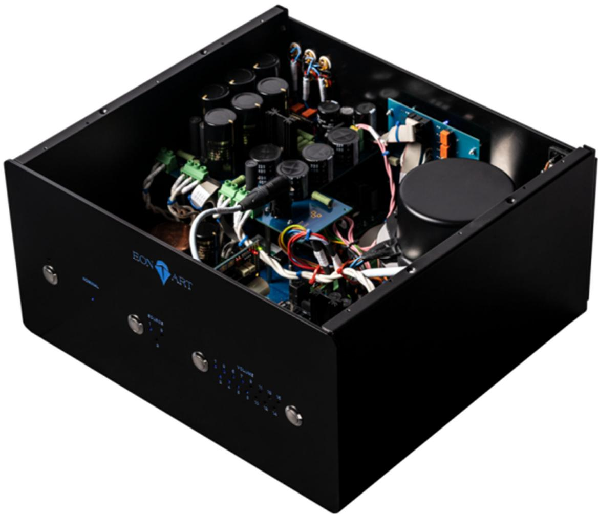
L'ensemble de l'électronique est placée dans un châssis usiné dans une tôle d'aciers rigide avec une façade avant en aluminium de 6 millimètres d'épaisseur en aluminium. Les boutons peuvent être noir ou argent selon votre choix.
